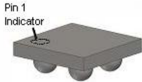
图 3. 1 x 1 毫米 WLCSP 封装, 凸块向下
